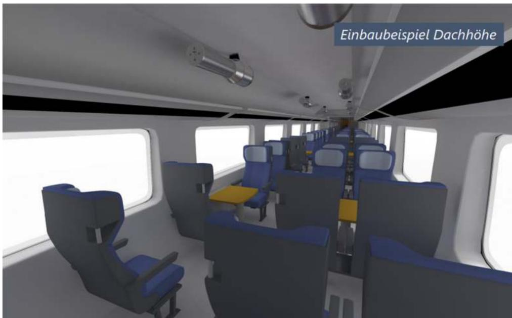
Abbildung 24: Biosafe Luftfilter Anordnung Fahrzeug
